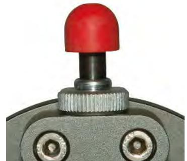
Wenn Sie kleine Durchmesser vermessen, kann es notwendig sein, auf die kürzere Federkappe BT 943094 zurückzugreifen. Diese hat außerdem einen kürzeren Federweg, was in manchen Fällen auch von Vorteil ist. In diesem Fall kann die Kappe auch durch die Verlängerung BT 948207 verlängert werden.
