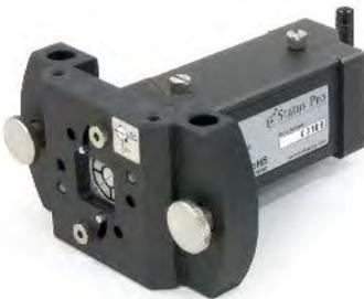
Der R545 ist ein sehr robuster und präziser 2D Laser-Positionsdetektor, der für lineare Messungen entwickelt wurde. Die Verbindung zur Anzeige- und Auswerteeinheit findet über Bluetooth statt. Betrieben wird der R545 über einen Li-Ion Akku aus Großserie, der extern geladen wird und damit eine kontinuierliche Messbereitschaft ermöglicht. Kombiniert mit der Software ProLine und einem Bluetooth Distanzmessgerät können X,Y und Z zeitgleich gemessen und dokumentiert werden.
